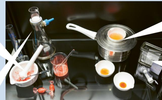
Die nun reinen Farbstoffe liegen in verdünnter Lösung vor und werden durch Verdampfen in der Porzellanschale zu einer konzentrierteren Lösung eingeeengt.
