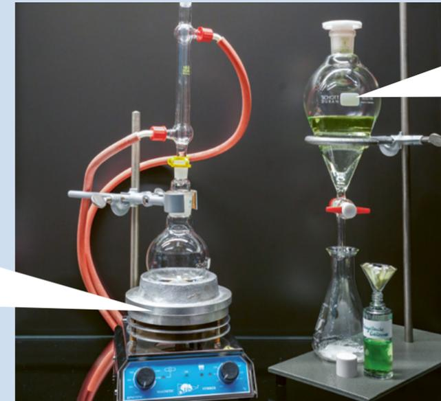
Im Rundkolben werden die Edukte – eine Carbonsäure und ein Alkohol – zusammen mit Schwefelsäure als Katalysator unter Rückfluss gekocht. Im aufgesetzten Kühler können die beim Sieden entstehenden Dämpfe kondensieren und in den Rundkolben zurückfliessen. Dabei reagieren die Edukte unter Abspaltung von Wasser zum Ester. Nach einer gewissen Zeit verändern sich die Mengen der Edukte und der Produkte nicht mehr. Das chemische Gleichgewicht ist erreicht.
